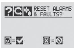
Figure 21. Écran Alarm/Fault Reset (Réinitialiser l'alarme/l'erreur)
